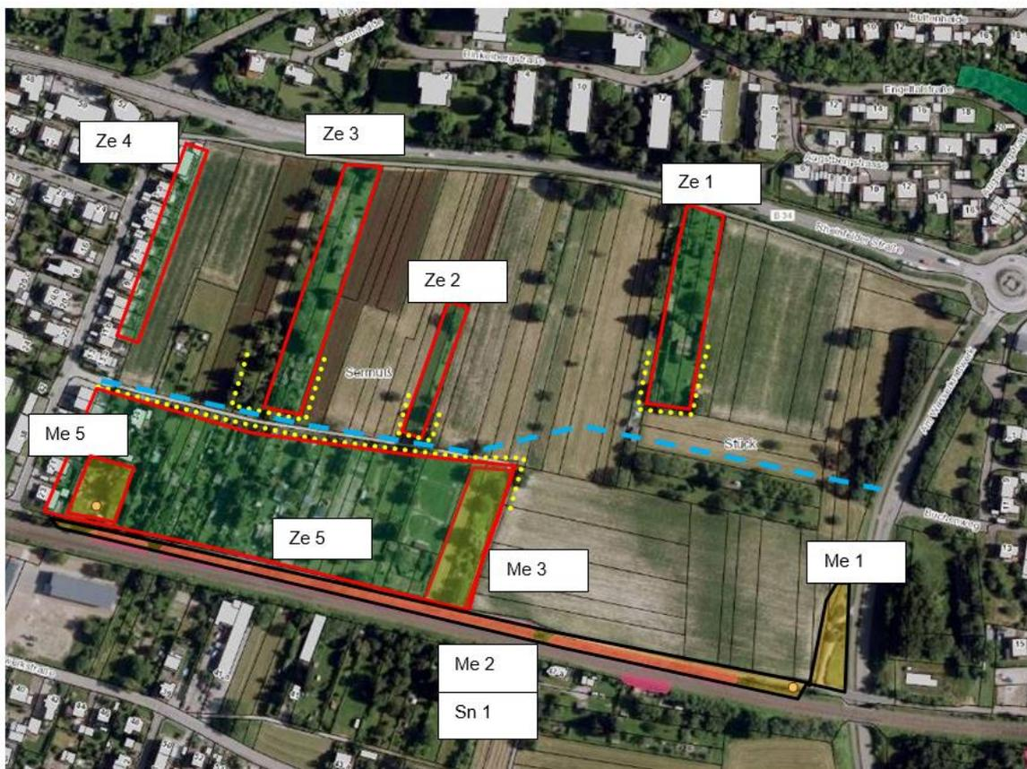
**Abbildung 10:** Übersicht über die Schutzmaßnahmen für den Leitungsbau (blaue Linie). Reptilienhabitate sind rot umrandet. Schutzzäune als gelbe Strichellinie dargestellt.
